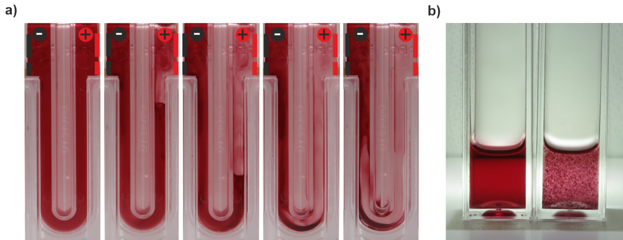
Abbildung 5.3: a) Elektrophorese einer 0,1 g/l P3HT-Dispersion in einer Kapillarzelle (Malvern Panalytical) bei einer Spannung von 50 V. Die Einzelbilder (von links nach rechts: 0 min, 15 min, 30 min, 45 min, 90 min) zeigen, dass sich die Partikel zur Kathode (schwarze, gestrichelte Linie) bewegen, während sich der Bereich um die Anode (rote, gestrichelte Linie) entfärbt. Da die Dispersion elektrisch sehr wenig leitfähig ist, verläuft das elektrische Feld nicht perfekt entlang der Kapillare. b) Flockung einer P3HT-Dispersion durch Salzzusatz (0,1 g/l P3HT, links in reinem EtOH, rechts eine halbe Stunde nach Zusatz von 10^{-3} mol/l NaBr).
