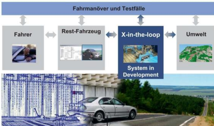
Abbildung 2.3: Anwendung des IPEK-X-in-Loop-Ansatzes am Beispiel einer Prüfumgebung für den Einsatz in Antriebsstrangentwicklung nach Albers und Behrendt et al. (2016) und Düser (2010)
