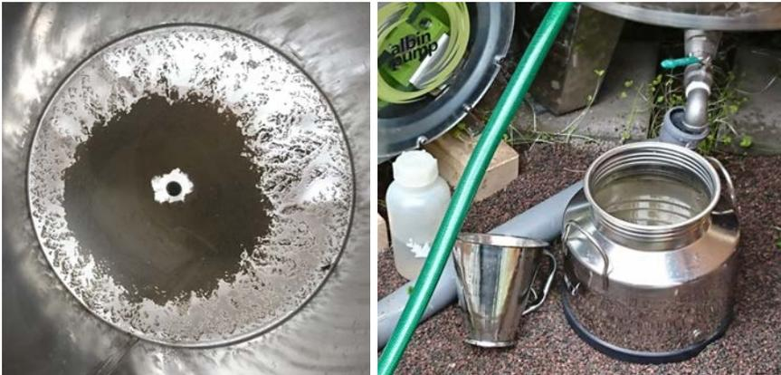
Abbildung 2.5: Sedimentierte Feststoffe am Boden des Feststoffsammlers und Entnahme der Feststoffprobe in Edelstahlkanne
