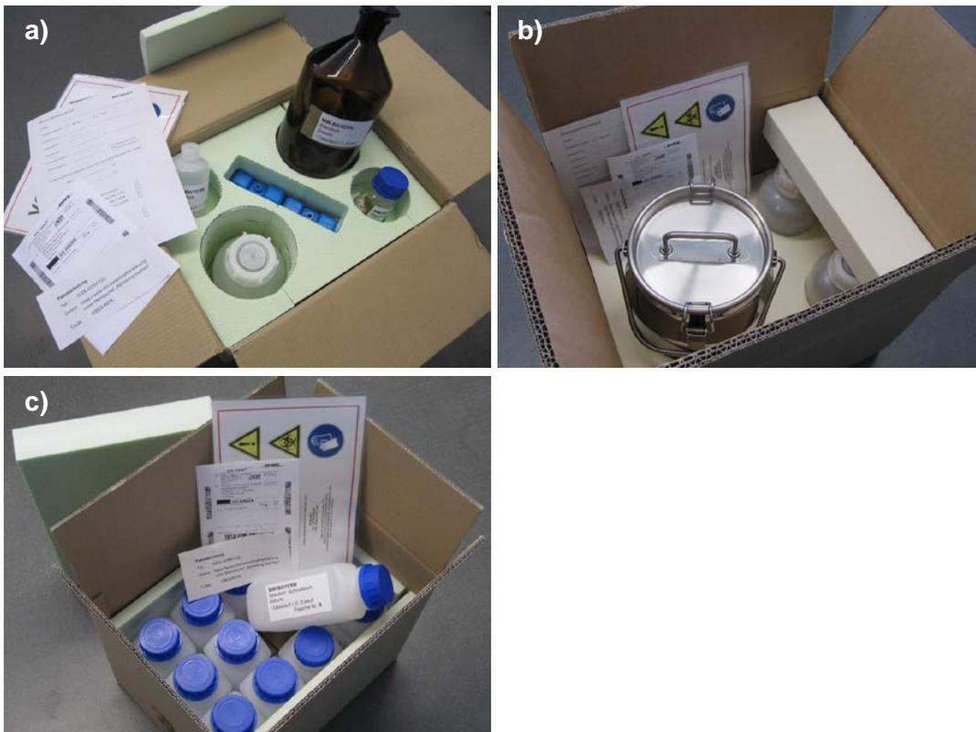
Abbildung 2.6: Transportbox für a) homogenisierte Stichprobe, b) Feststoffprobe und c) Flaschen aus automatischem Probennehmer
