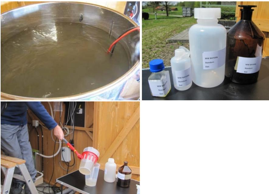
Abbildung 2.4: Homogenisierung mit Tauchpumpe im Feststoffsammler, Probenahmeflaschen, Entnahme der homogenisierten Mischprobe aus dem Feststoffsammler.
