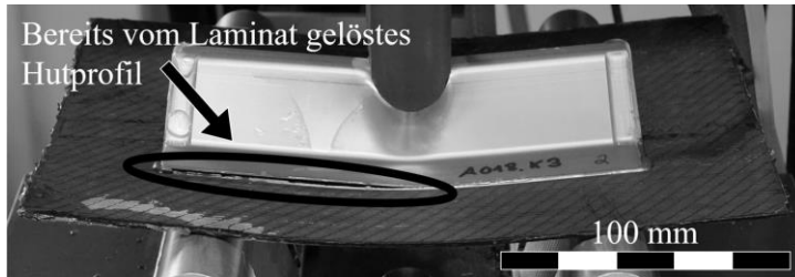
Abbildung 5.35: Mechanisch vorgeschädigter differentieller Hybridträger im LSV ( N \approx 35500 , F_{max} = 8,5 \text{ kN} ), nach [134] #
