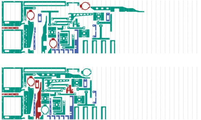
**Abbildung 3.12** Schachtelung 94 als Beispiel für einen deutlichen Unterschied der Blechlänge in Abhängigkeit von der Sortierung. Oben: Aufsteigende Sortierung nach größter  $x$ -Koordinate. Unten: Aufsteigende Sortierung nach kleinster  $x$ -Koordinate.
