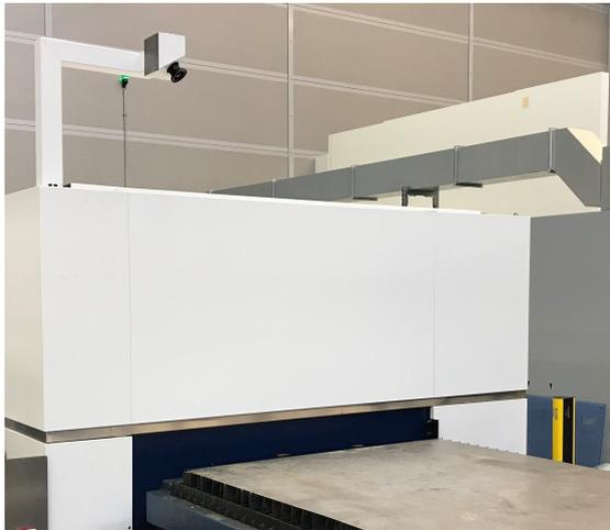
**Abbildung 2.20** Die Position des Kameraarms an der Maschine.
