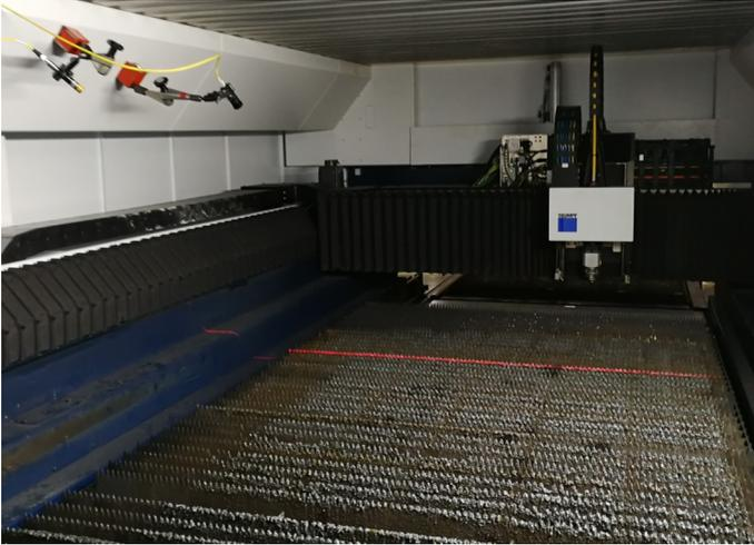
**Abbildung 2.3** Der Laser-Triangulationsaufbau im Innenraum der LFM.
