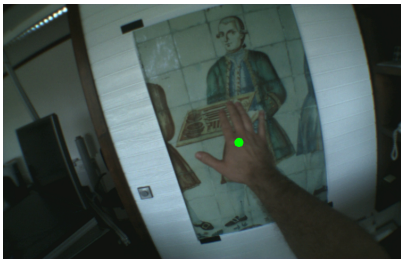
(e) Eingabebild und Resultat Shape-Partikelfilter-Tracking
