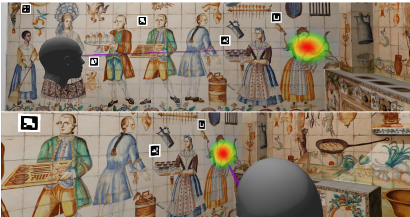
Abbildung 3.21: Gewichtung durch in die Szene projizierte Gauß-Verteilung. Aus Sicht der Person (unteres Bild) ist die visuelle Schärfe des Blickes nun in alle Richtungen gleich ausgedehnt. Wechselt die Perspektive des Betrachters, verzerrt sich entsprechend die Einfärbung der betrachteten Region.
