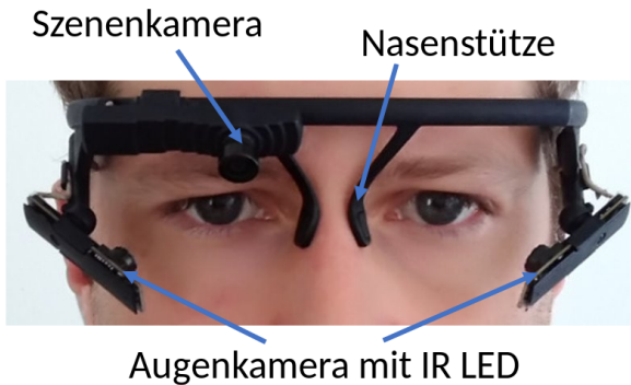
Abbildung 2.3: Mobiles Blickmessgerät pupil von pupil labs [Kas14]
