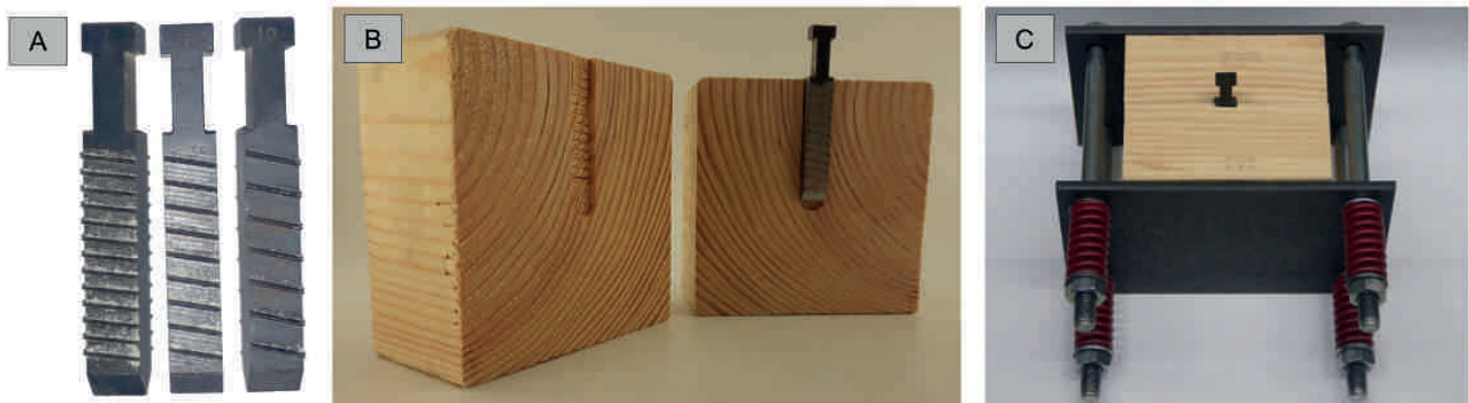
Bild 3 Verwendete Schraubenprototypen (A), Prüfkörperhälften mit Nut (B), Eingespannte Probe mit Schraubenprototyp (C). (Bild: KIT)
