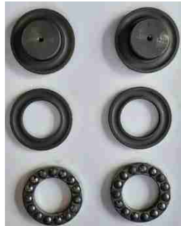
Abbildung 2. Axiallager nach der Beschichtung und vor den Versuchen.
