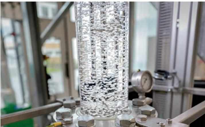
**Bild 1.7:** Hydrodynamik in Blasensäulen im homogenen Strömungsregime:  $d_R = 100\ \text{mm}$ , Wasser/Luft
