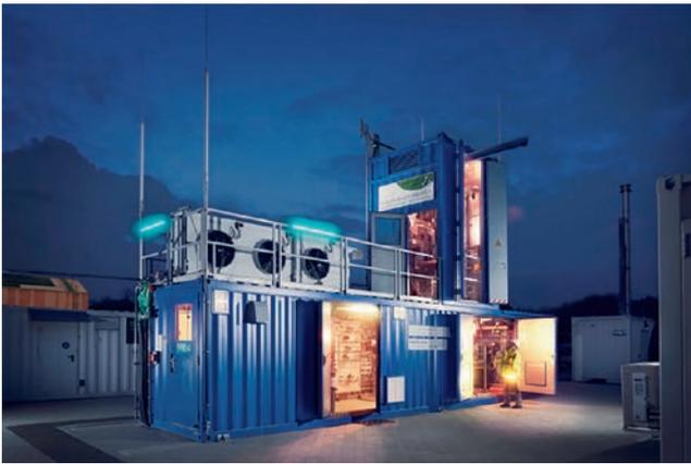
**Bild 1.4:** Fotografie der Dreiphasen-Methanisierung am „Energy Lab 2.0“ des KIT
