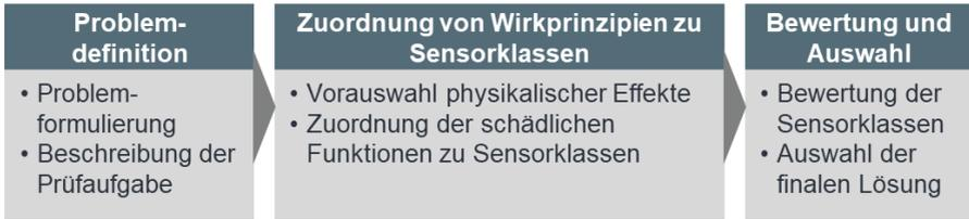
Abbildung 5-1: Vorgehen zur systematischen Auswahl geeigneter Sensorik
