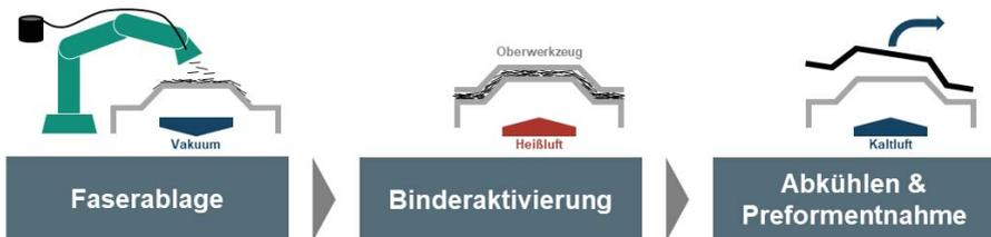
Abbildung 2-3: Verfahrensablauf der Faserspritzverfahren (eigene Darstellung in Anlehnung an (Harper & Turner et al. 2006a))
