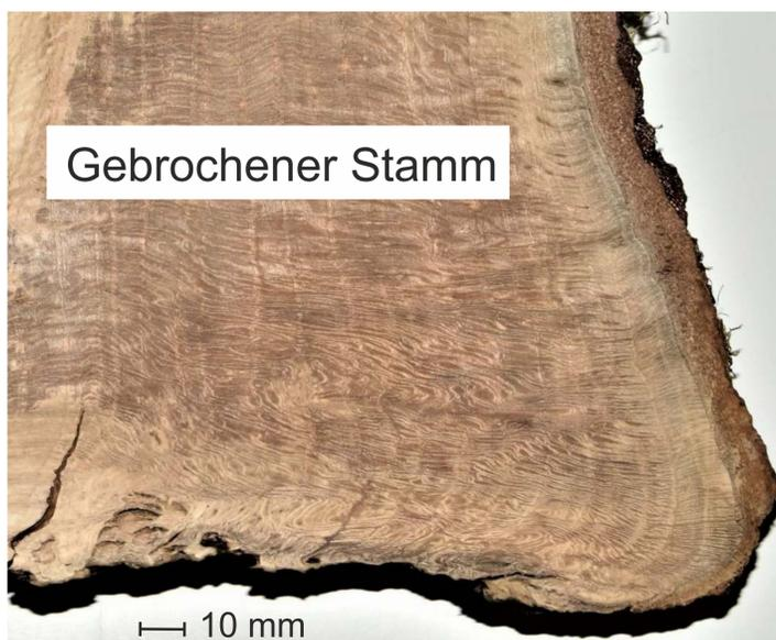
Längsschnitt durch die Bruchstelle.
