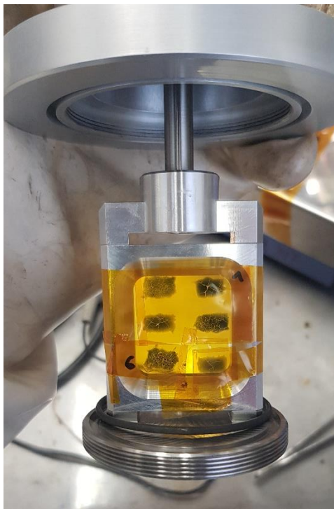
Abbildung 3.2: Ein XAS-Probentransporter mit Probenhalter, welcher in der Glovebox mit sechs Proben präpariert wurde. Der Probenhalter ermöglicht einen Transport von Proben ohne Luftzutritt.
