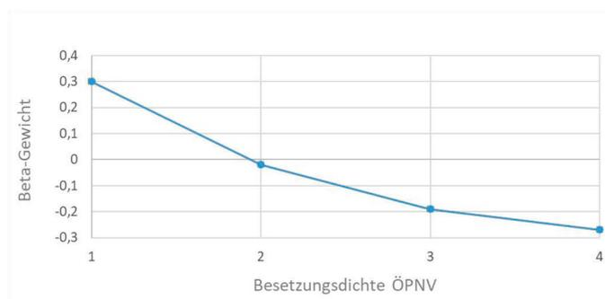
Abbildung 3b: Sensitivitätsfunktion der Shuttle-Besetzungsdichte
