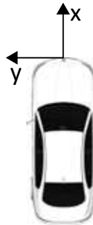
Abbildung 3.3: Fahrzeug mit Koordinatensystem in vorderer Stoßstange
