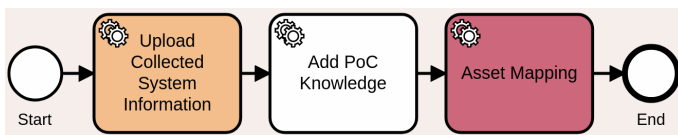
Abbildung 3.57: KF/MC-Workflow zur Weiterverarbeitung von Informationen aus dem PoC-Netzwerkverkehr.
