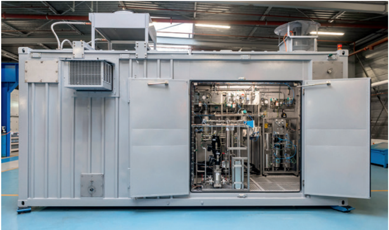
Abb. 2: Im Rahmen des Teilprojekts MethFuel entwickeltes PEM-Elektrolyse-System
