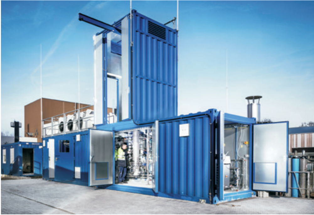
Abb. 3: Pilotanlage zur Erzeugung von erneuerbarem Methan mittels Drei-Phasen-Methanisierung
