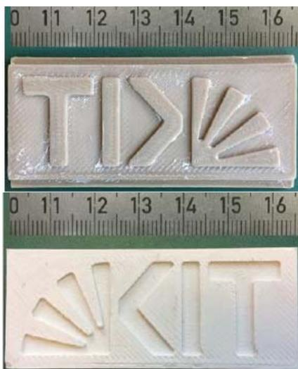
**Bild 7** Oben: PEEK-Formeinsatz „D“ nach dem Ausbau, unten: Keramischer Grünling.
