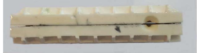
Bild 8 Gesinterte Reaktorhälfen mit Glaslot gefügt
