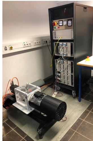
Abbildung 6.1: Aufbau des Prüfstands nach dem Blockdiagramm mit Gegenüberstellung des physikalischen Aufbaus, bestehend aus dem Maschinenbett sowie Umrichterschrank mit Leistungselektronik und Signalverarbeitung
