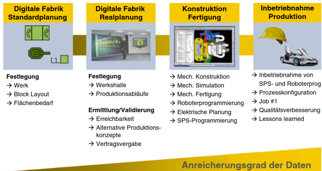
Abbildung 2.3.: Planungsphasen von automatisierten Produktionsanlagen [24]
