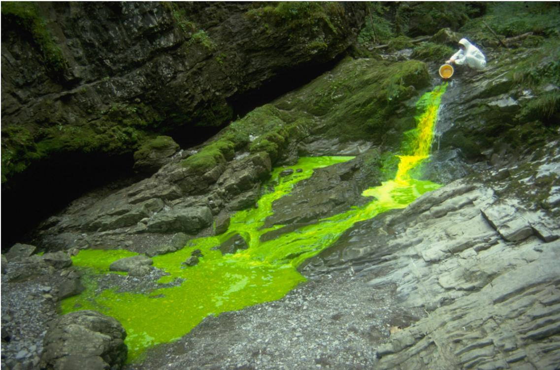
Abbildung 2.11: Uranin Injektion in einem Karst-Grundwasserleiter in Hochifien-Gottesacker.
