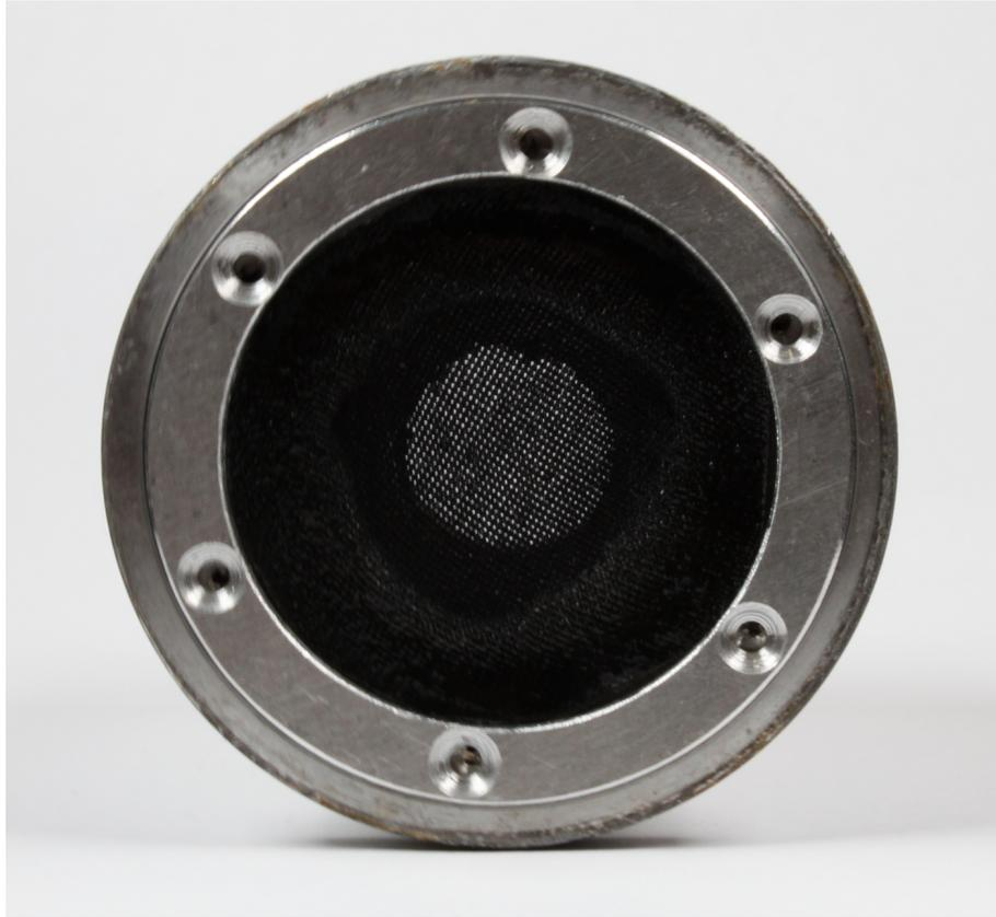
Abbildung 6.5: Verbindungsstück zur Sandsäule mit Nylon Mesh anstelle des Sinterglases
