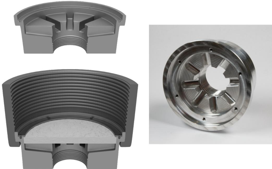
Abbildung 4.2: Die Zu- und Ablaufstücke in das poröse Medium bestehen aus Aluminium und Sinterglas und ermöglichen einen möglichst homogenen Durchfluss des porösen Mediums, während sie gleichzeitig *deadzones* minimieren.
