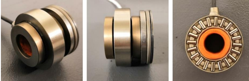
Abbildung 6.14: Paket aus Kraftmessring, Scheiben und Nadellager (Yavas, 2019)
