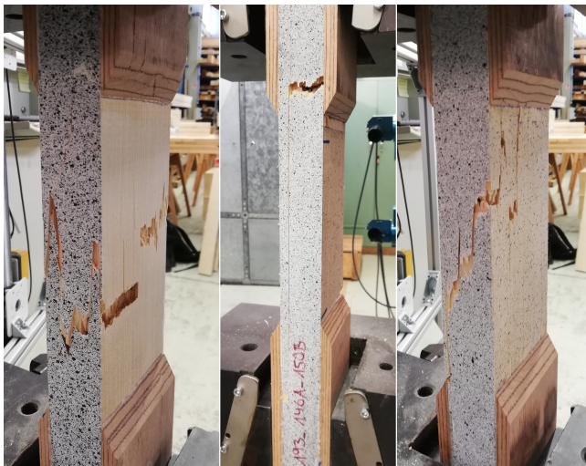
Bild A.13: Bei den Zugversuchen an fehlerfreien Proben beobachtete Versagensfälle; v. l. n. r.: Versagen in der untersuchten Zelle, Versagen an der Einspannung, Mischbrüche
