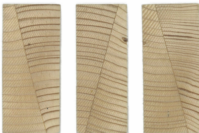
Bild 3.3: Zu Elementarlamellen aufgetrennter Querschnitt eines SLH-Balkens
