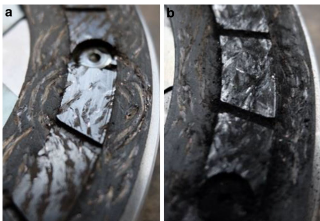
Abb. 11 Fotoaufnahmen der gewickelten Reibbeläge nach (a) dem Einlauf sowie (b) nach Schädigung durch Erhöhung der Gleitgeschwindigkeit
