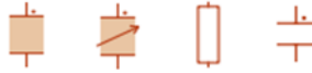
Abb. 36: Magnetische Komponenten in Plecs, von links nach rechts: Permeanzblock, variable Permeanz, magnetischer Widerstand, Luftspalt
