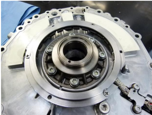
Abb. 73: Stahlabschirmblech auf Zwischenflansch montiert
