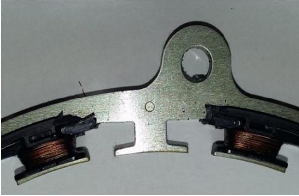
Abb. 44: Statorzahn zur Ermittlung der geometrischen Abmaße als Grundlage für die Modellbildung [C]
