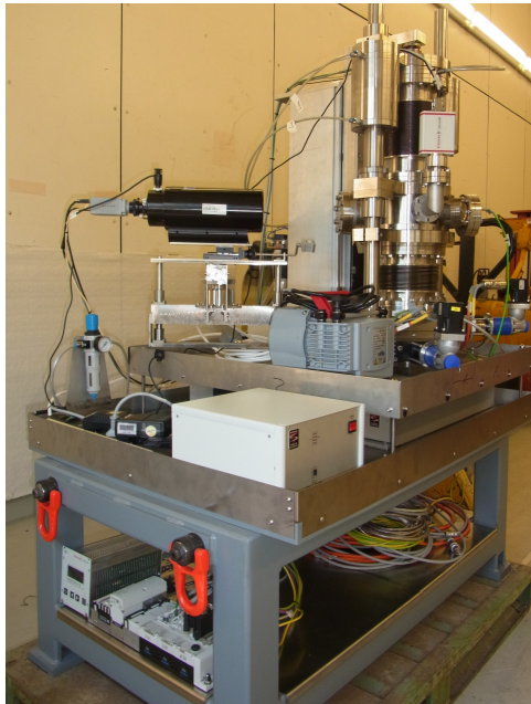
Abbildung 3.6: Anlagenverbund mit allen Teilelementen, die in der Heiße Zelle untergebracht werden müssen
