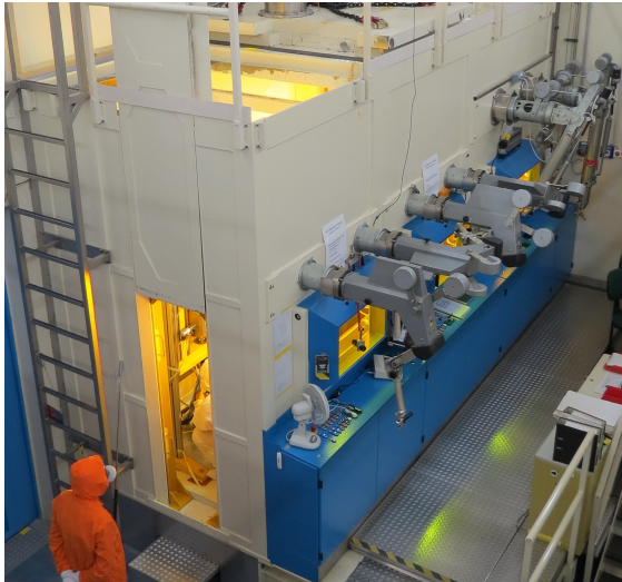
Abbildung 3.4: Materialprüfzelle des FML während einer Intervention mit geöffneten Zugängen für Wartungsarbeiten
