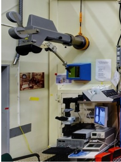
Abbildung D.6: Arbeitsplatz der optischen Mikroskopie an der Metallografiezelle
