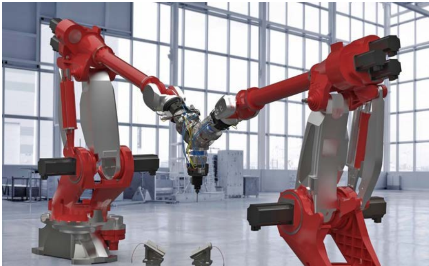
Bild 2. Visualisierung gekoppelter Roboterkinematiken vom Typ Comau NJ290-3.0
