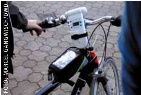
Mit Messfahrzeugen und Fahrrädern messen die Forschenden die Temperaturen in Hitzeperioden und erstellen eine bioklimatische Karte des gesamten Gebiets Using measuring vehicles and bicycles, the researchers measure temperatures during hot spells and produce a bioclimatic map of the entire area
