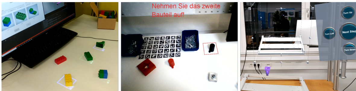
Abbildung 31: Bildprojektion durch Beamer (links), Optische Transparenz durch Epson Moverio BT-35E (mittig) (Fraider, 2019) sowie durch Microsoft HoloLens 2 (rechts)
