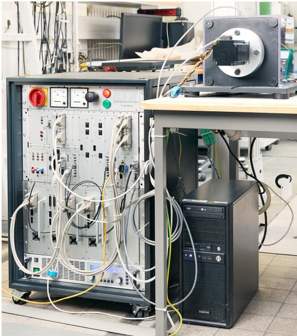
Abbildung 5.1: Prüfstand bestehend aus Schaltschrank, Maschinensatz und PC<sup>6</sup>
