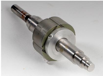
Abbildung 4.10: Rotor der PMSM mit Rotorblechpaket, Permanentmagneten, Rotorwelle und beidseitigen Wuchtscheiben.
