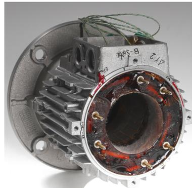
Abbildung 4.9: Statorgehäuse mit sichtbarem Verguss und Anschlusspunkten.
