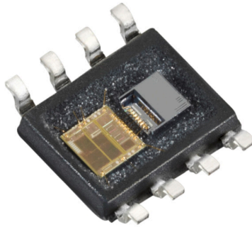
Abb. 2.10: Innenansicht eines Kunststoffgehäuses, in das Beschleunigungssensorchip (rechts) und ASIC (links) eingebettet sind. Der Aufbau ist übertragbar auf Drehratensensoren oder Kombi-MEMS. Bildquelle: Robert Bosch GmbH
