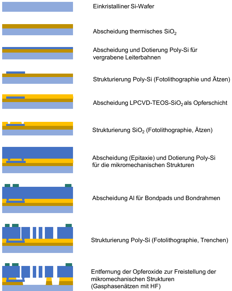
Abb. 2.6: Schematische Übersicht über den Prozessverlauf eines Sensorwafers, dargestellt für den Querschnitt eines Einzelchips.
