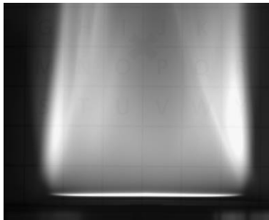
Abbildung 43: Ermittlung der Absorptionslänge mittels graphischer Analyse für \phi = 2,9 , T_v = 473 K und p = 1 bar a .
