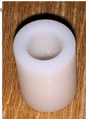
2234 ZrO 2 pellets OD=7.93 mm, ID=4.75 mm
