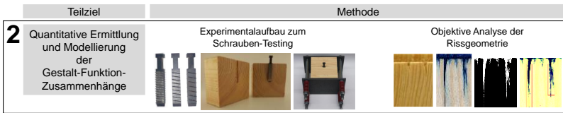
Abbildung 6.20: Entwickelte Methoden zur Ermittlung der Gestalt-Funktion-Zusammenhänge zwischen den Gewindepameter, der Rissgeometrie im Versagen und des Haltevermögens.
