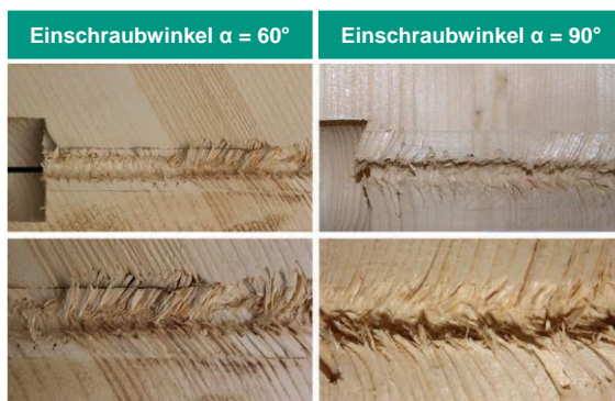
Abbildung 2.12: Sägeschnitte entlang der Schraubenachse zur Untersuchung des Versagens im Gewindekontakt bei axialer Belastung für unterschiedliche Einschraubwinkel. (Ayoubi, 2014), veränderte Darstellung
