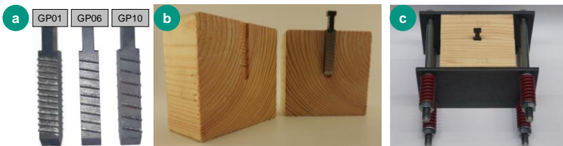
Abbildung 6.9: Verwendete Gewinde-Testobjekte mit unterschiedlichen Gewindesteigungen (a), Prüfkörperhälften mit Nut (b), Eingespannte Probe mit Gewinde-Testobjekt (c). (Hölz, Dörner & Matthiesen, 2021)
