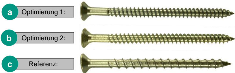
Abbildung 8.1: Im Flachbackenwalzverfahren hergestellte optimierte Gewindegestalten (a, b) sowie eine Referenzgewindegestalt (c). Diese Holzschrauben wurden anhand der in Tabelle 16 vorgestellten Gewindep Parameter gefertigt.
