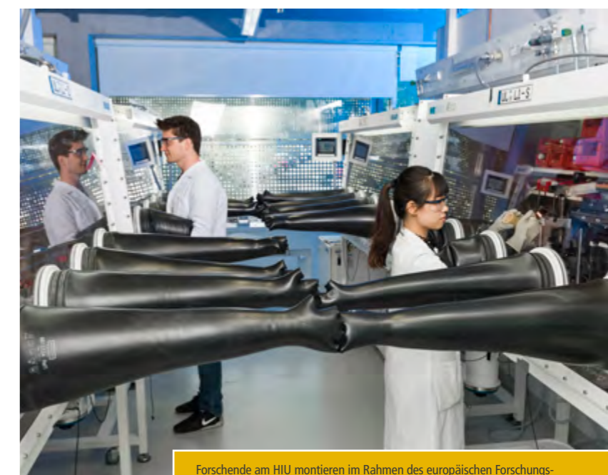
Forschende am HIU montieren im Rahmen des europäischen Forschungsprojekts E-MAGIC Magnesiumbatterien unter Argon-Schutzgas.
