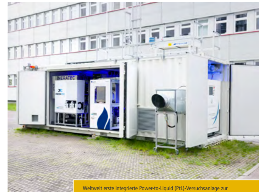
Weltweit erste integrierte Power-to-Liquid (PtL)-Versuchsanlage zur Synthese von Kraftstoffen aus dem Kohlenstoffdioxid der Luft.
