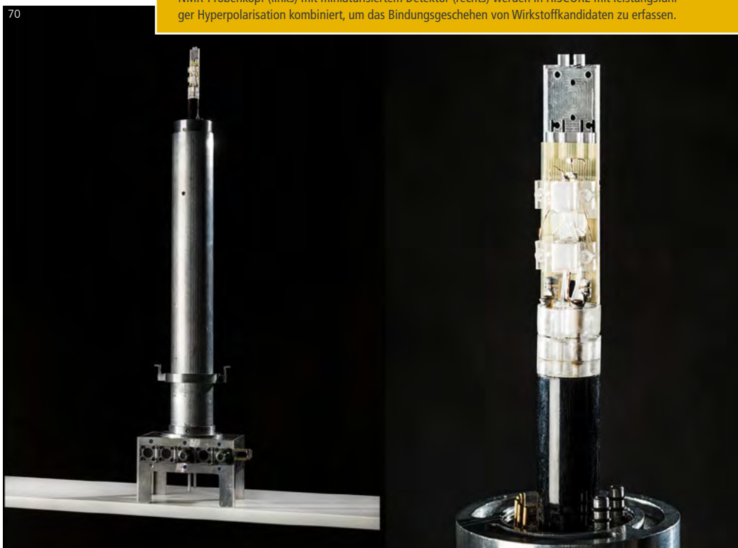
NMR-Probenkopf (links) mit miniaturisiertem Detektor (rechts) werden in HiSCORE mit leistungsfähiger Hyperpolarisation kombiniert, um das Bindungsgeschehen von Wirkstoffkandidaten zu erfassen.
