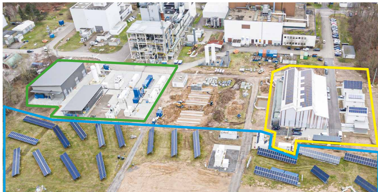
Abb. 1: Luftaufnahme des Energy Lab 2.0 am KIT Campus Nord in 2020: grüner Rahmen: Anlagenverbund mit P2X-Technologien, blauer Rahmen: Solarstromspeicherpark mit Freiflächenphotovoltaikanlage, Redox-Flow Großspeicher und Li-Ionen-Großspeicher, gelber Rahmen: Smart Energy System Simulation and Control Center mit drei Experimentalgebäuden (Foto: Markus Breig/KIT, Markierung: Simon Waczowicz/KIT)
