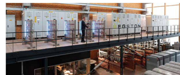
Abb. 6: Die Power-Hardware-in-the-Loop-Laborumgebung (PHiL) erlaubt es, reale Hardwarekomponenten in ein simuliertes 1 MVA-Netz einzubinden und beispielsweise Stresstests zu unterziehen.
