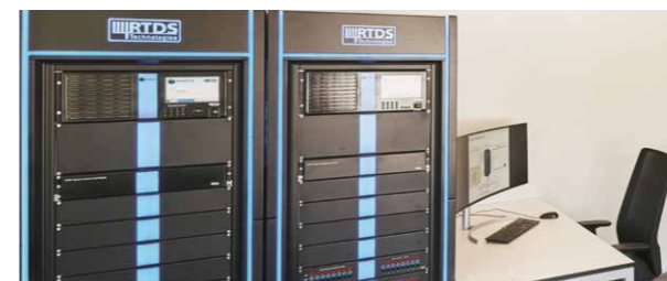
Abb. 4: Im Energy Grids Simulation and Analysis Laboratory (EGSAL) wird die Topografie der künftigen Energienetze unter der virtuellen Einbindung von Komponenten simuliert, die am Campus Nord selbst nicht vorhanden sind.
