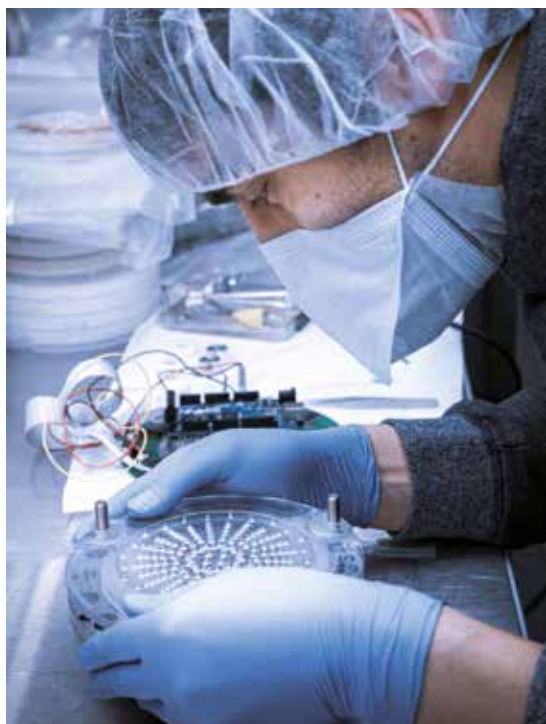
Der Detektor von KATRIN registriert kein Licht, sondern Elektronen – er ist sozusagen das „Auge“ des Experiments
