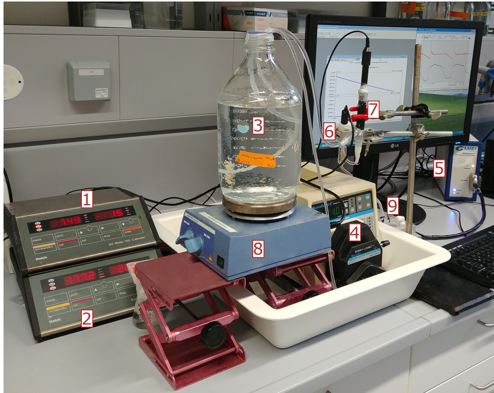
Abbildung 3.3.: Versuchsaufbau für elektrochemische Versuche. 1: pH-Meter, 2: Konduktometer, 3: Behälter mit Versuchslösung, 4: Peristaltikpumpe, 5: Potentiostat, 6: Leitfähigkeitsmesszelle, 7: pH-Elektrode, 8: Magnetrührer, 9: CDI-Zelle
