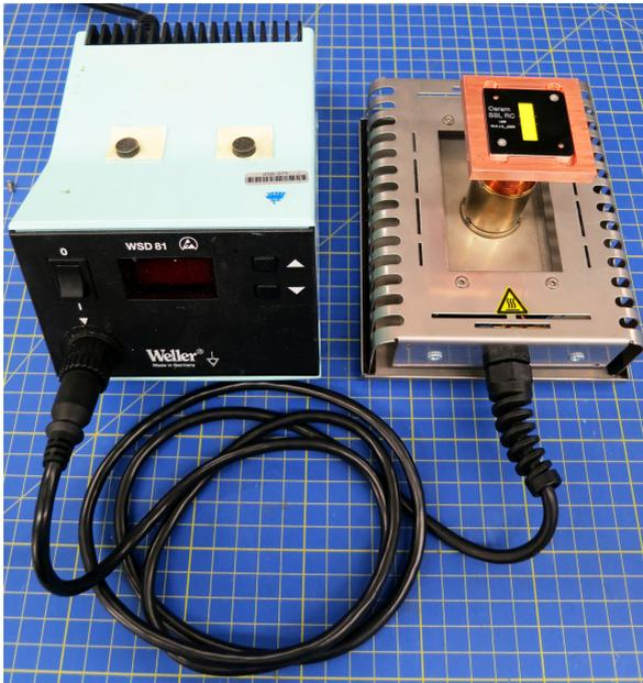
**Abbildung 6.3:** Umfunktionsiertes Lötbad zur Erwärmung des Konverters zur Ermittlung des Emissionskoeffizienten.
