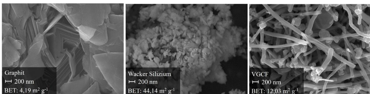
Abbildung 10: REM Aufnahmen der Ausgangsmaterialien mit BET Oberfläche.
