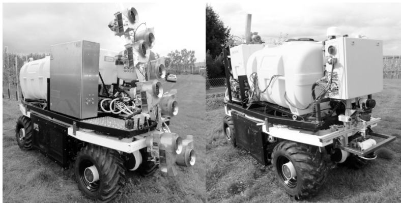
Abb. 5.11 »elWObot« mit sensorgesteuertem Pflanzenschutzgerät im Praxistest
