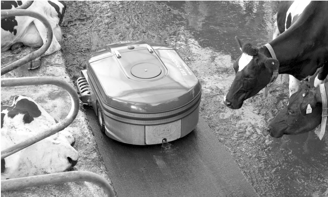
Abb. 5.7 Reinigungsroboter »Discovery« bei der Arbeit
