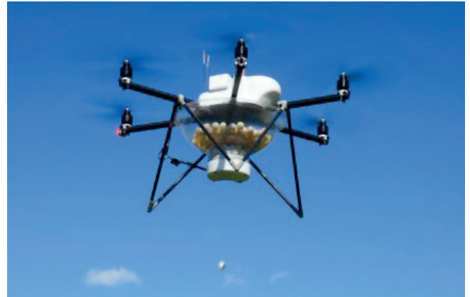
Abb. 2 Drohne bei der Ausbringung von Schlupfwespen gegen Maiszünslern
