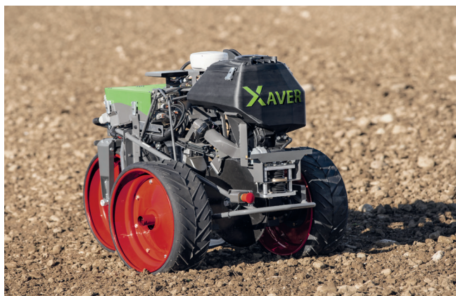
Abb. 3 Fendt »Xaver«: im Schwarm operierende Robotereinheiten
