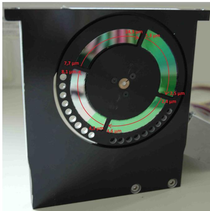
**Abbildung 4.3:** Filtrerradscheibe im Filtrerradmodul
