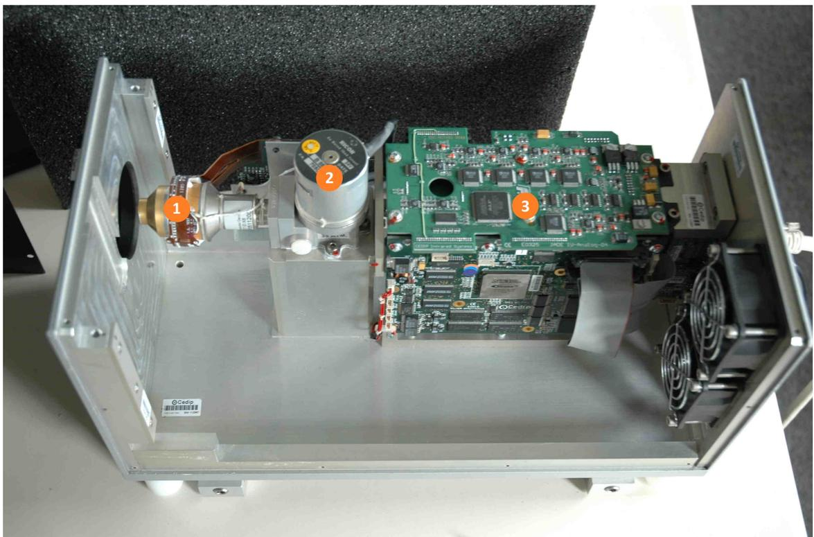
**Abbildung 4.2:** Kamerabasisystem: ① Sensor, ② Stirling-Kühler, ③ Signalverarbeitung
