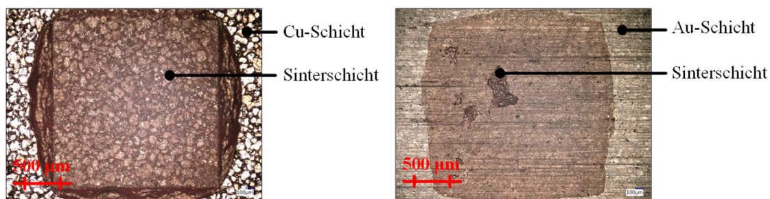
Abbildung 69: Untersuchungen der Bruchzonen der Cu-Sinterschicht auf einer Cu- (links) bzw. Pd/Au-Oberfläche mittels Lichtmikroskopie (30 x Vergrößerung) nach einer Auslagerungsdauer der Proben von 8 h
