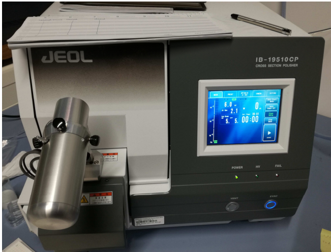
Abbildung 116: Cross-Section-Polisher als Präparationswerkzeug für die Herstellung von präzisen Schlifften
