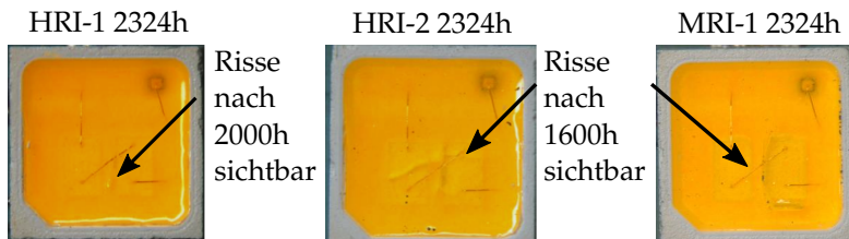
Abbildung 4.60: Relative Spektren der Osconiq (CRI-70-Mischung) für verschiedene Silikone und Auslesezeiten bei der SSLT-Bedingung von 150 °C und 120 mA sowie das Schadensbild für ausgewählte Silikone.
