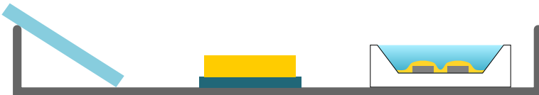
Abbildung 3.9: Schematische Darstellung der Anordnung der Proben zur Alterung auf dem Ofenblech. Von links nach rechts: Klarsilikonplättchen, Konversionselement und LED.
