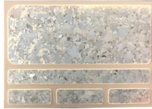
Abbildung 5: Si 3 N 4 -AMB Substrat mit oberseitiger Leiterbahnstrukturierung
