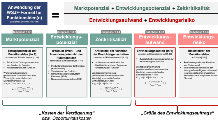
Abbildung D.16: Anwendung der Weighted Shortest Job First (WSJF) Formel zur Priorisierung von Funktionsidee(n)
