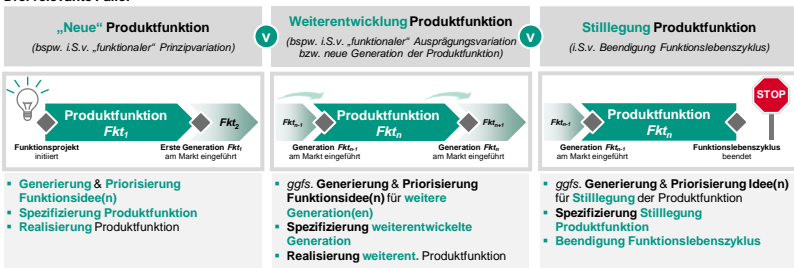
Abbildung 5.19: Fallunterscheidung beim Produktlinien-übergreifenden Spezifizieren von Produktfunktionen (Albers, Fahl, Hirschter, Endl et al., 2020, S. 673; Fahl, Hirschter & Albers, 2021, S. 6) 74
