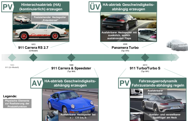
Abbildung E.1: Historische Meilensteine der Entwicklung von Produktfunktionen der Fahrzeugaerodynamik bei der Dr. Ing. h.c. F. Porsche AG 101
