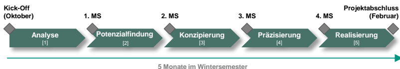
Abbildung 3.5: Die fünf Phasen des Live Labs IP – Integrierte Produktentwicklung (Albers, Bursac, Heimicke et al., 2017, S. 1017; IPEK - Institut für Produktentwicklung am Karlsruher Institut für Technologie (KIT), 2020)
