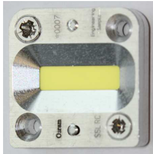
Abbildung 3.6.: Kameraaufnahme einer Konverterbaugruppe des Laserscanner-Moduls. Die nutzbare Konverterfläche beträgt 18 \times 4,5 \text{ mm}^2 . Aus [72]
