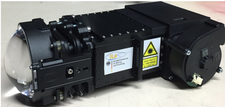
Abbildung 3.8.: Komplett montiertes Laserscanner-Modul mit Kühlkörper, Lüfter und Sekundäroptik, welche die erzeugte Lichtverteilung auf die Fahrbahn projiziert. Aus [67]
