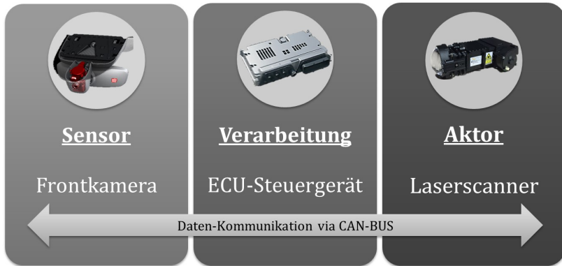
Abbildung 3.9.: Schema der Elektronikarchitektur zur Ansteuerung eines Laserscanners
