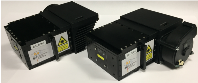
Abbildung 3.7.: Zentrale Scanner-Einheit mit Kühlkörper (links) und zusätzlichem aktiven Lüfter (rechts). Deutlich zu erkennen ist die kleine Lichtaustrittsfläche des gelben Konverters von 18 \times 4,5 \text{ mm}^2 . Aus [73]
