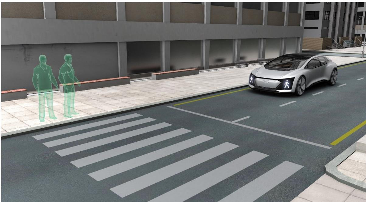
Abbildung 6 Darstellung von Information als Symbol auf an der Fahrzeugfront befestigten Displays [4]
